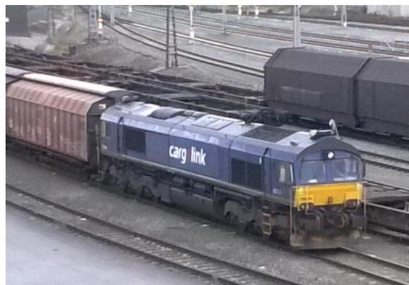
Sul fronte privato opera CargoLink, con vecchie macchine diesel T66 di chiara origine britannica, ma anche con ben più moderne 185 elettriche della famiglia TRAXX di Bombardier, in leasing da Railpool, omologate solo per la circolazione in Norvegia e Svezia.
