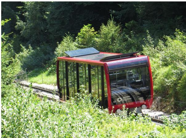
I lavori hanno comportato il rinnovamento dell'alimentazione e delle vetture mediante revisione generale dell'impianto attuata da Doppelmayr e Leitner. Le nuove cabine lunghe 12m c.ca sono state prodotte dalla Sigma (azienda francese che ha realizzato anche le cabine della rinnovata Funicolare del Renon, vedi precedenti mail) e possono trasportare 80 persone ciascuna.
