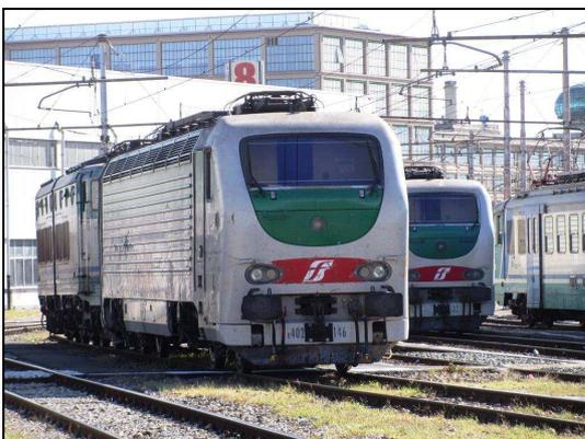
Sempre presso l'impianto torinese sostano anche alcune macchine della cosiddetta "Lunga Percorrenza" ovvero le E402B: in questo scorcio possiamo osservare la **E402B.132** e la **E402B.146** assegnate a Milano, realizzate da Sofer ed Ansaldo nel 1998/99. Proprio la 146 era una delle macchine che vennero dotate di 3 pantografi onde poter circolare sia sulla rete italiana che su quella francese e pertanto alle tensioni 1,5 kW - 3 kW in continua e 25 kW in monofase.
