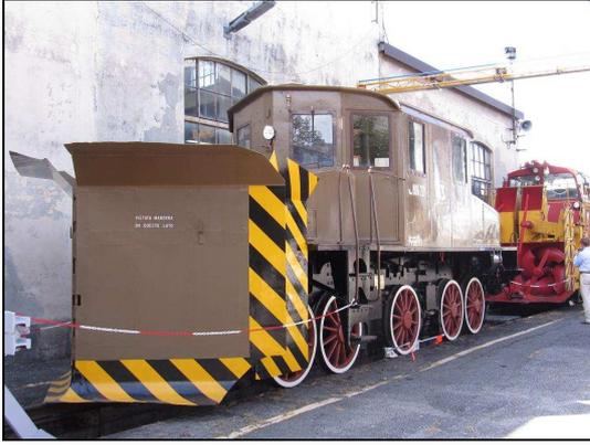
**Carro Spartineve Vnx806.221 "ex Trifase", ricostruzione Off. Fiore nel 1966 dalla loco elettrica trifase E550.173 del 1921**
