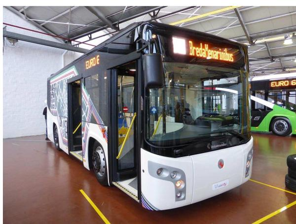
La versione 12m 3 porte avrà una capacità di 21 posti a sedere e da 78 ad 87 posti in piedi per una capacità totale di 101, 107 oppure 109 passeggeri.
