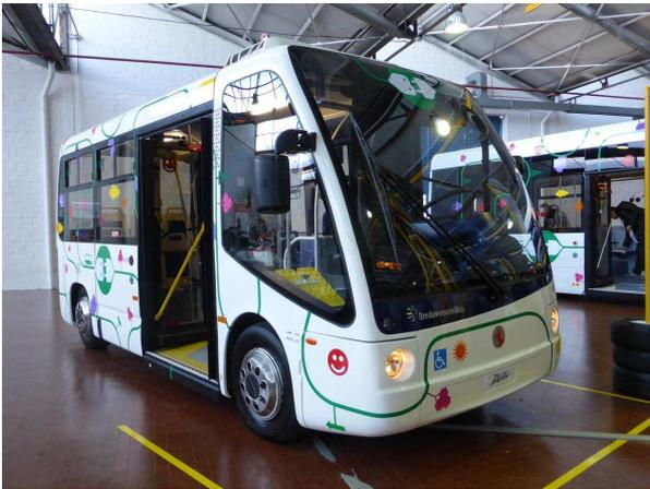
La parte elettrica è fornita da un motore elettrico per 80kW nominali e 140kW di picco sfoderando una velocità massima dichiarata di 80 km/h.
