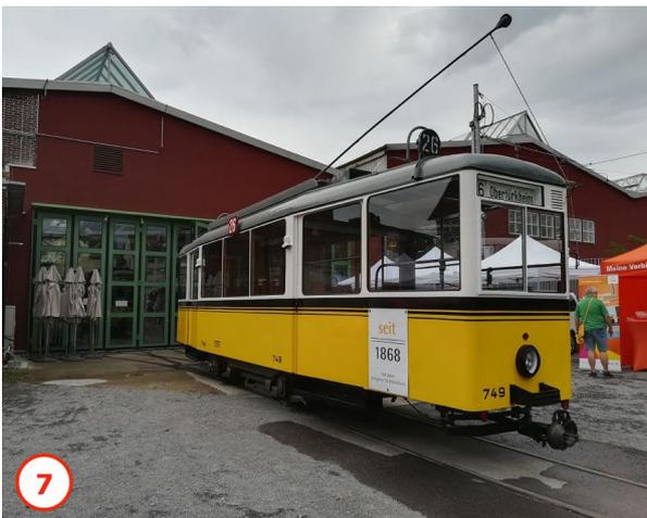
Motrici a 2 assi di vari gruppi e modelli. La tipo "A", di recente restauro, è stata dotata di asta a rotella in luogo del pantografo presente sulle altre motrici (**foto 5, 6, 7**).
