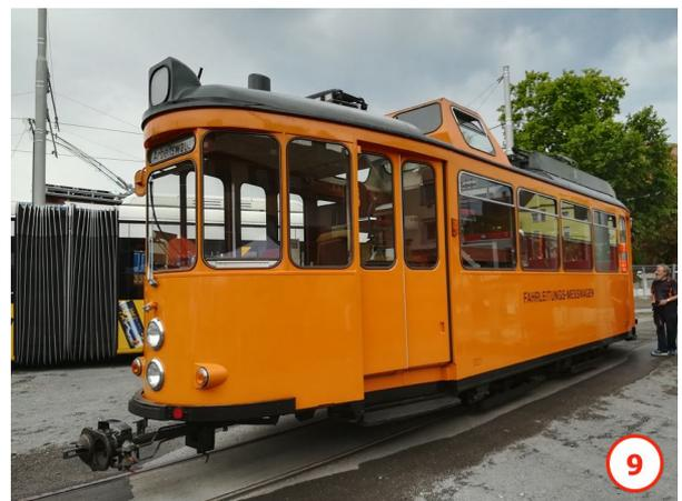
Due mezzi di servizio, un classico locomotore con cabina centrale (**foto 8**) ed una vettura dotata di torretta per controllo catenaria (**foto 9**).
