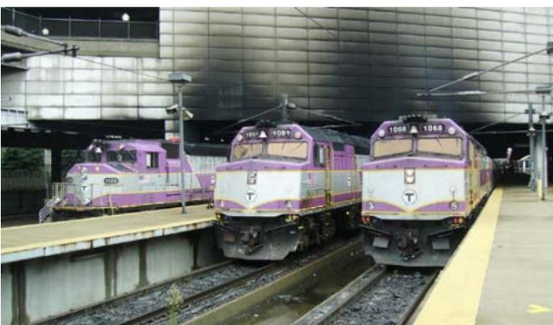
Foto 15 - Dal lato opposto alla semipilota, ecco le classiche motrici GP40 ( a sinistra ) ed F40PH, qui in livrea MTBA. I segni scuri sul muro sono dovuti agli scarichi dei motori di queste macchine
