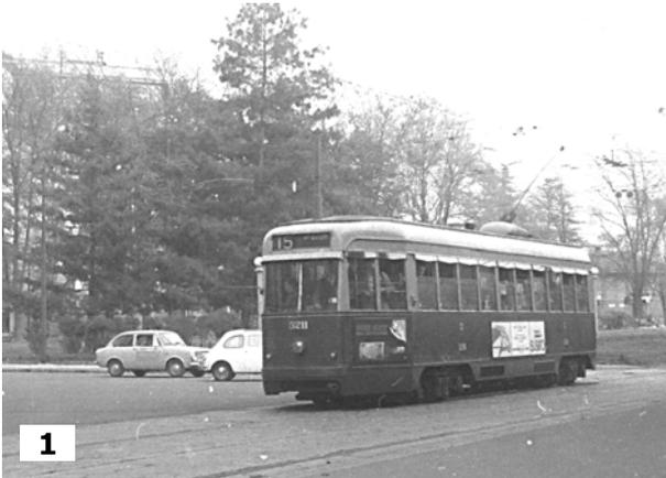
In realtà, si trattava di "accorpamenti" di vetture monocassa - le **5200** (foto 1, *Collezione Kaiblinger*) e le **5300** - che, con l'inserimento di un corpo centrale, realizzato ex-novo (ad eccezione del prototipo per il quale venne utilizzata una vettura della serie **5400**), si trasformavano in capienti vetture articolate a tre casse.
