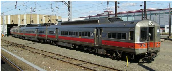
Foto 6 - Vecchi elettrotreni CDOT serie M2 di costruzione Budd in deposito a New Haven
